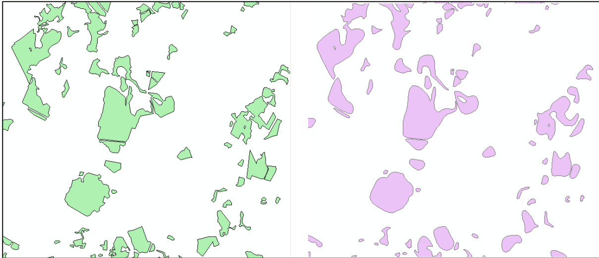
6 pav. Suformuotų ekologinio junglumo arealų formos optimizavimas formuojant plastiškesnes ribas (funkcija Smooth Polygon ) (kairėje - prieš; dešinėje - po).
